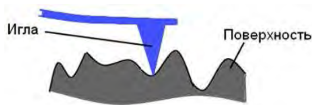
Рис. 35. Принцип действия профилометра
