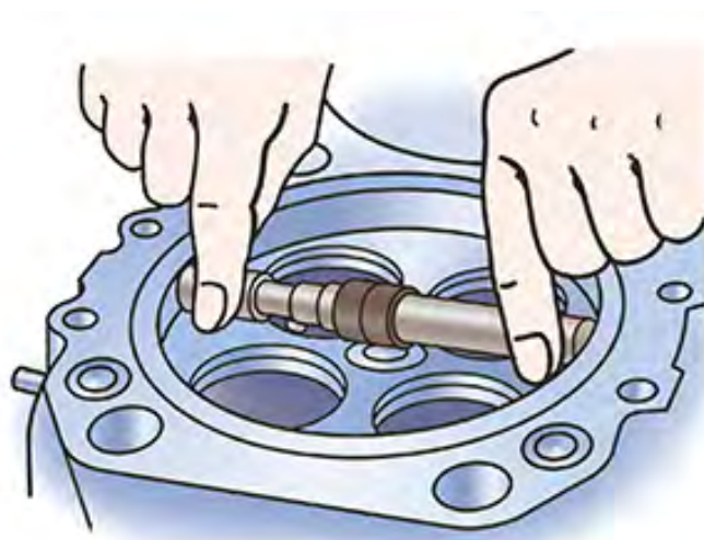
Рис. 15. Схема измерения штихмасом
